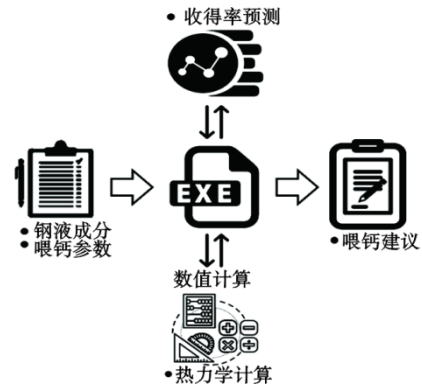
图 5 精准钙处理指导软件工作流程示意图 [22]
